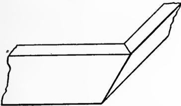
FIG. 117.—HOPPER JOINT.
