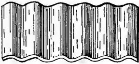
FIG. 208.—CORRUGATED STEEL FASTENERS.
