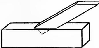
FIG. 114.—ANGLE JOINT.
