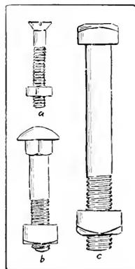
Fig. 230. a. Stove-bolt. b. Carriage-bolt. c. Machine-bolt.
