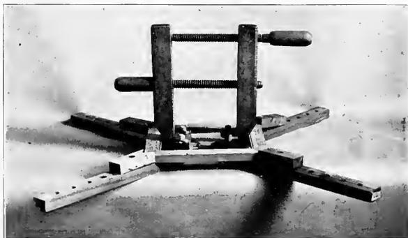
Fig. 254. Picture-Frame-Clamp.
