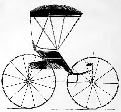
DROP-FRONT EXTRA-SEATED COAL-BOX BUGGY.—\(\frac{1}{2}\) IN. SCALE.
