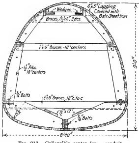
FIG. 213.-Collapsible center for a conduit.
