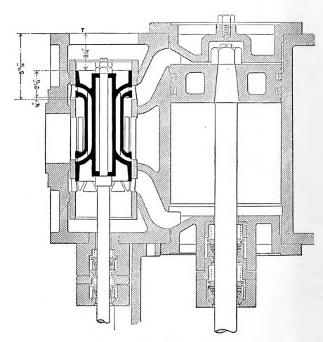
FIG. 147. — THE HIGH-PRESSURE VALVE.
