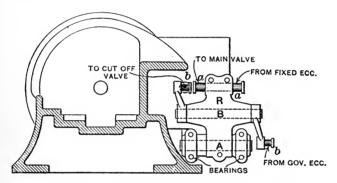
FIG. 100. — SECTION SHOWING ROCKER ARM.
