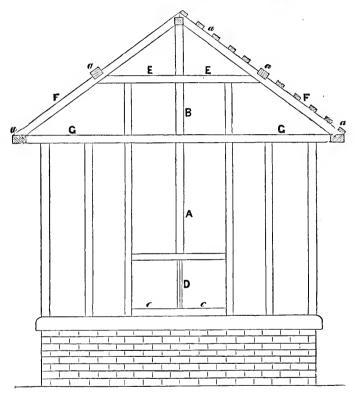
Fig. 15.—Timber Framing.
