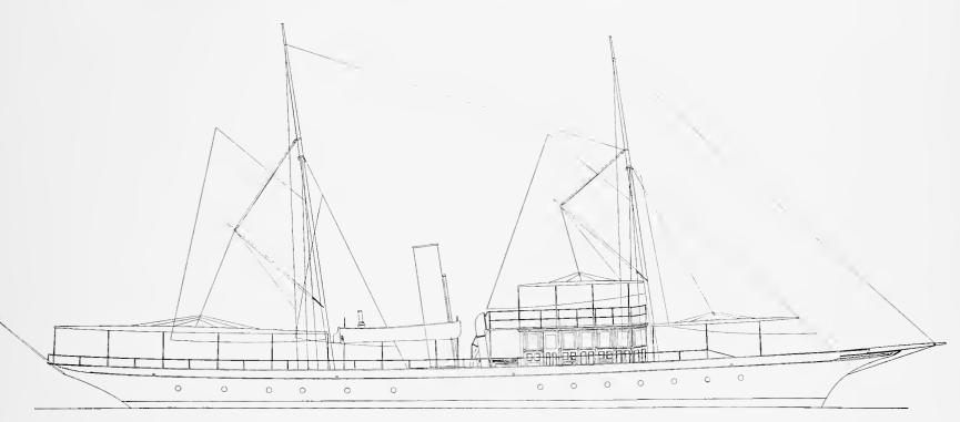
SHEAR PLAN OF THE COMPOSITE STEAM YACHT ALCEDO.
