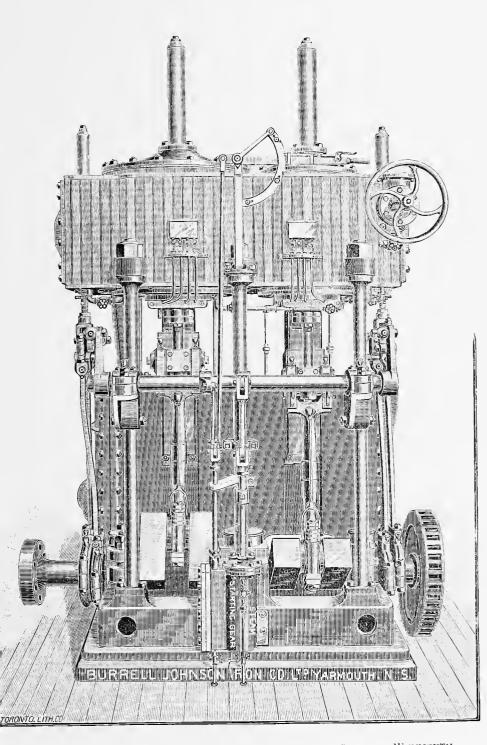
TANDEM COMPOUND SURFACE CONDENSING ENGINE OF THE STEAMER WEYMOUTH.
