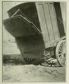
SHOWING LAYERS OF STREET DIRT AS DEPOSITED IN BOX BY THE AIR, WHICH CARRIERS THE SWEEP-INGS TO THE BOX.
