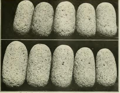
FIG. 3. MOBTAR BLOCKS AFTER RATTLER TEST, 3,600 REVOLUTIONS.
