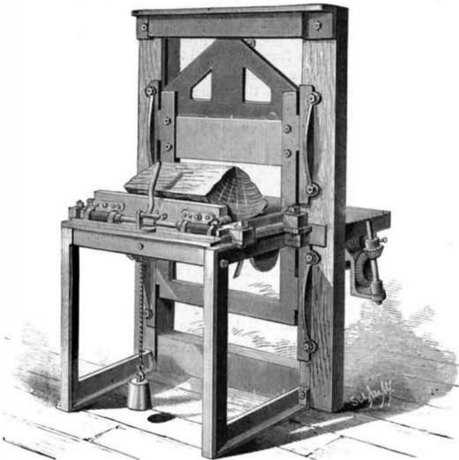
Fig. 2.—TREVOR & CO'S SHINGLE-CUTTING MACHINE.
