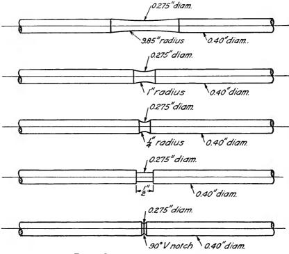
FIG 4. SHAPES OF SPECIMENS TESTED.
