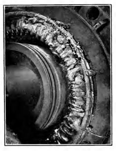
FAILURE OF LARGE TURBO-GENERATOR.
