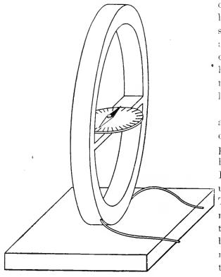
FIG. 2. -- A GALVANOMETER.
