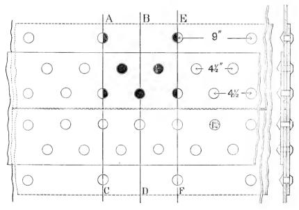
A TRIPLE-RIVETED BUTT-STRAP JOINT.
