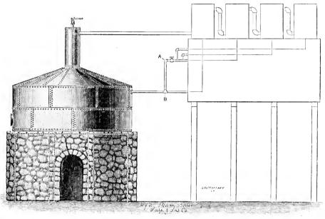
FIG. 1.-THE STILL BEFORE THE EXPLOSION.
