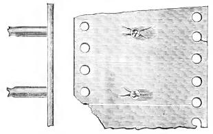
CORROSION AROUND STAY BOLTS, - FIG. 2.
