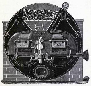
Fig. 49 .- Proctor's Mechanical-Stoker.
