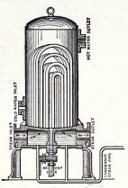
Fig. 104 .- Feed-water heater.
