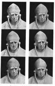
FIGS. 487 to 492.—Study of a head by Prof. E. Lantéri. Examples of reproduction in half-tone using different screens, 487-50 per in.; 488-57 per in.; 439-too per in.; 490-125 per in.; 491-150 per in.; 492-175 per in.
