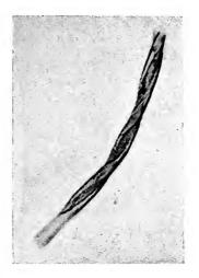
FIG. 5. TYPICAL TWISTED COTTON FIBRE
