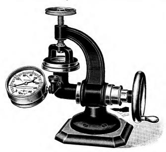
FIG. 25. EDWARDS' HYDROSTATIC PAPER TESTER
