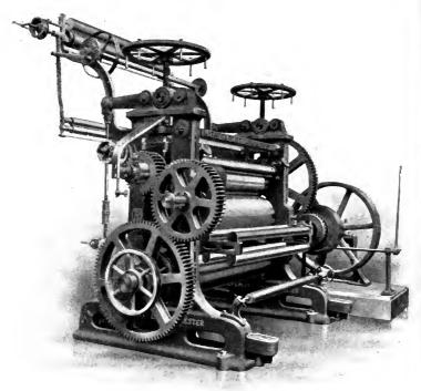
FIG. 24. 3-BOWL HEAVY FRICTION GLAZING MACHINE
