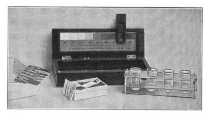
Fig. 201.—Complete Kienböck quantimeter. (Schall.)
