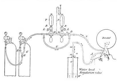
FIG. 152.—Tiegel's overpressure apparatus.
