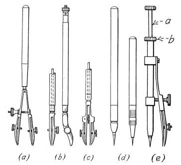
Fig. 33.-(a) Railrcad pen, (b) curve pen, (c) double curve pen, (d) prickers, (e) drop pen.
