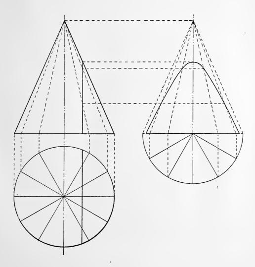
Plate II. The Parabola.
