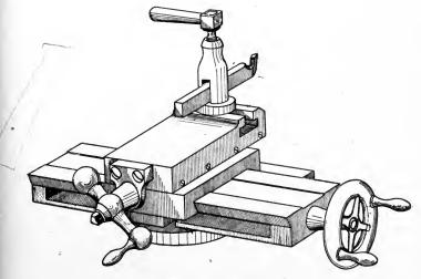
Fig. 94. Hand Lathe Slide Rest
