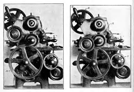
Fig. 164. Simple Lathe Gearing
