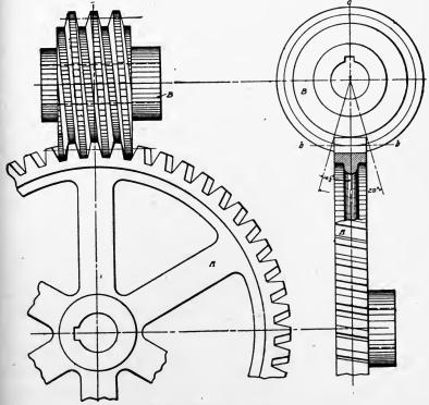
Fig. 272. Simple Worm Gear
