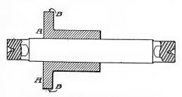
Fig. 110. Stuffing-Box Gland Held on Mandrel
