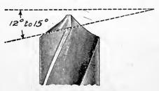
Fig. 71. Cutting Edge Clearance
