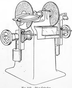
Fig. 249. Disc Grinder
