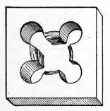
Fig. 82. Threading Die
