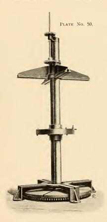
VERTICAL CYLINDER BORING-BAR.
