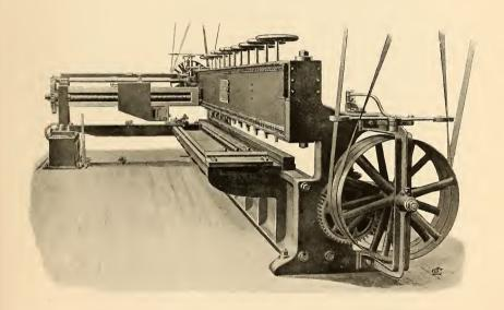
PLATE-PLANING MACHINE—FOR PLATES 22 FEET LONG.
