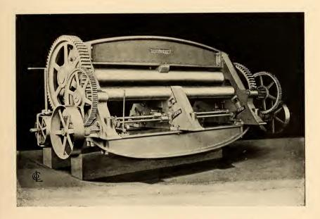
16" SHIP-PLATE ROLLS.—14 FEET BETWEEN HOUSINGS.
