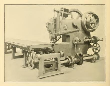
26" PUNCHING MACHINE—WITH AUTOMATIC SPACING TABLE.
