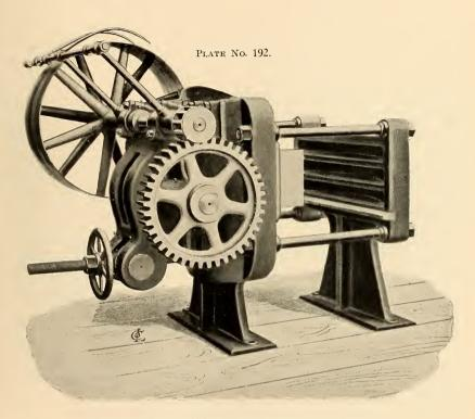
POWER STRAIGHTENING AND BENDING MACHINE.
