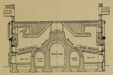
FIG. 52.-Longitudinal Section ; Horsfall Destructor.
