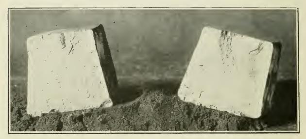
FIG. 226a.—CHILL TEST OF LOW-SULPHUR IRON.
