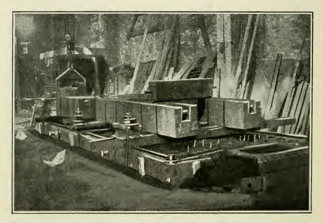
.FIG. 267.--PLANER TABLE MOLD CLOSED AND READY FOR POURING.
