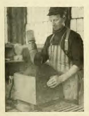
FIG. 3.—PEENING THE SAND AGAINST THE SIDES OF THE FLASK.
