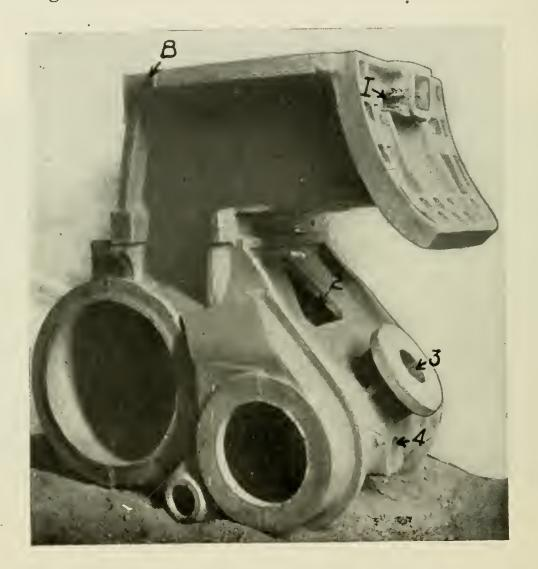
FIG. 108.—SUPERHEATER LOCOMOTIVE CYLINDER CASTING.
