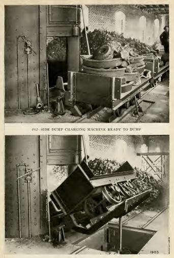
1903-SIDE DUMP CHARGING MACHINE IN DUMPING POSITION
