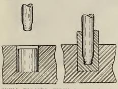
SHELL FORGING—FIRST OPERATION OF PIERCING THE BILLET.
