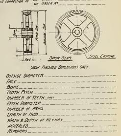
FIG. 2.—PARTICULARS REQUIRED FOR MACHINE MOULDED GEARS.
