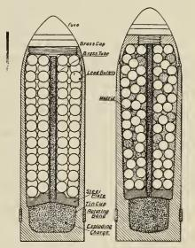
FIG. 2. TYPICAL FORMS OF COMMON SHRAPNEL.
