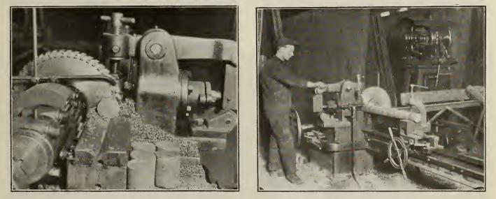
FIG. A-NEWTON SAW CUTTING SHELL BILLETS FROM THE STEEL BAR.
