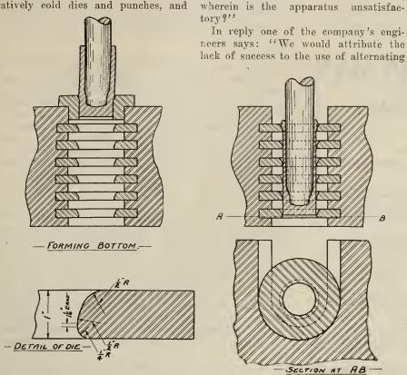
SHELL FORGING-DRAWING-OUT OPERATION IN SECOND PRESS.
