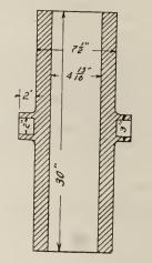
FIG. 3. INGOT MOLD.
