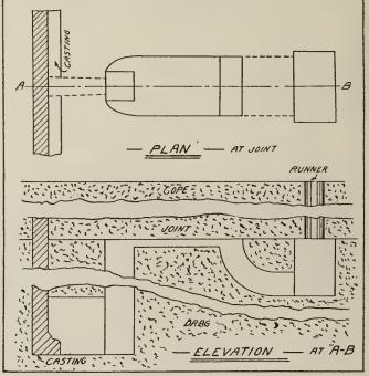
BLOCK GATE ENTERING CASTING AT BOTTOM.
