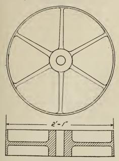
FIG. 1. PULLEY TO BE MOLDED.
