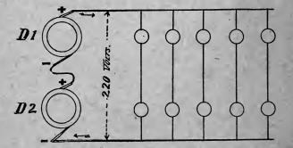
FIGURE 22.-MULTIPLE SERIES SYSTEM FOR IO LAMPS.
