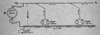
FIGURE 24 -STREET RAILWAY TROLLEY SYSTEM.
