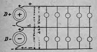
FIGURE 23.—EDISON 3 WIRE SYSTEM SUPPLYING IO LAMPS.
