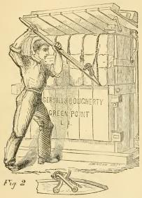
Fig. 13.—INGERSOLL'S BALE ROPE TIGHTENER.
