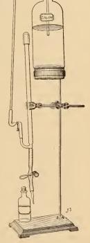
Fig. 1.—Titration apparatus for determining acidity of milk.
