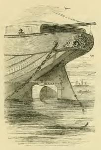
FIG. 1. SCREW STEAM-VESSEL, SHOWING THE FAN.
