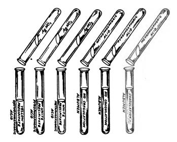
FIG. 45.—THE PHOSPHORIC ACID TEST
