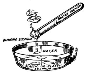
FIG. 46.-HOW PLASTIC SULPHUE IS MADE
