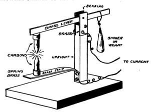
FIG. 189.—Experimental Arc Lamp.
